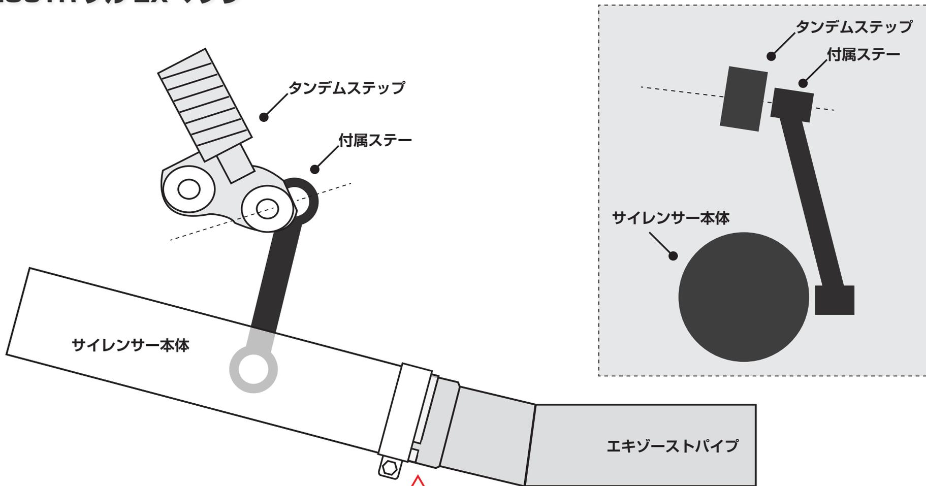
※エキゾーストパイプのサイレンサー側は若干太くなっております。サイレンサー装着時はこの太い部分に合わせてバンドを固定下さい。
