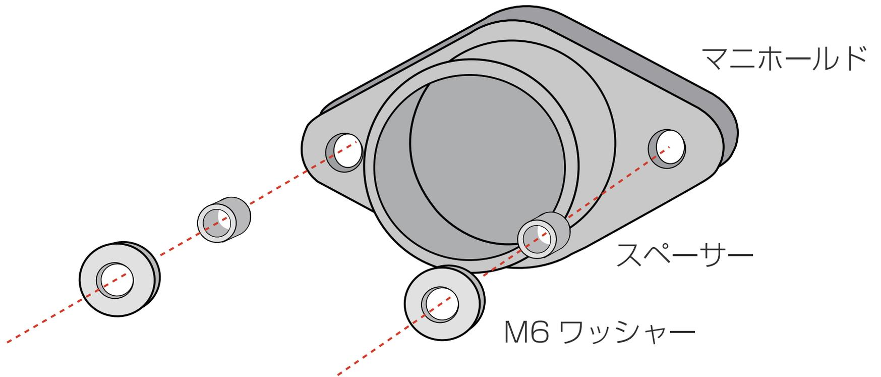
純正のボルトを使用してマニホールドを取り付け
