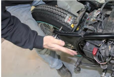
ボルト・ワッシャ・フレーム・カラー・ストラットの順で通し、ナットを仮止めします。(写真左)
