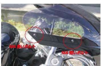
\*スクリーンを装着します。手前の穴はステーと共に締めになりますので、長い方のボルトをご使用下さい。
