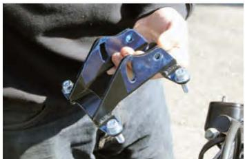
\*付属のプレートを、先ほど車体に装着したプレートに連結させます（ボルト類仮止めで）
