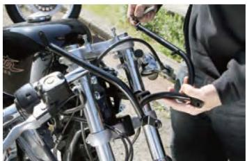
\*カウル固定ステーを、車体側のステーに装着します。（ボルト類仮止めで）
