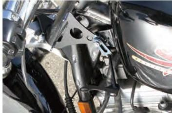
\*車体左側も同じようにステー、プレートを装着します（ボルト類仮止めで）
