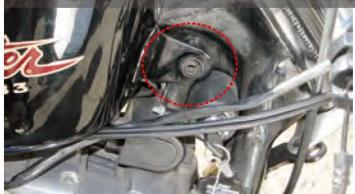
\*タンク前側のボルトを外します。※ホーン等が装着されている場合は移設が必要となります。
