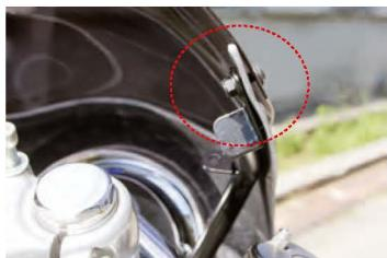
\*スクリーンを装着します。手前の穴はステーと共に締めになりますので、長い方のボルトをご使用下さい。※スクリーンのボルトは締めすぎにご注意下さい
