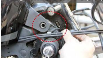
\*タンク前側のボルトを外します。※ホーン等が装着されている場合は移設が必要となります。
