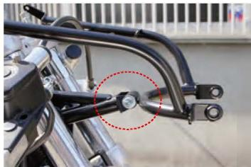
\*カウル固定ステーを、車体側のステーに装着します。(ボルト類仮止め)
