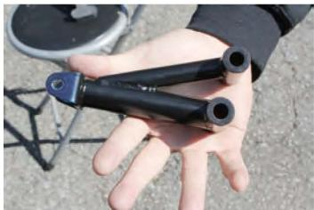
\*付属のブラケットを、車体側固定ステーに差し込みボルトで固定します(ボルト類仮止め)
