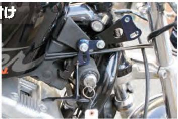
\*羽型のステーを外側に、三角のプレートと一緒に付属のボルトで差し込みます。
