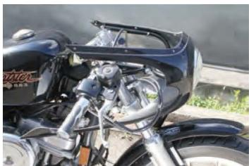
\*カウル下部を、羽型ステーに固定します。この時、付属のM5ボルトをご使用下さい。
