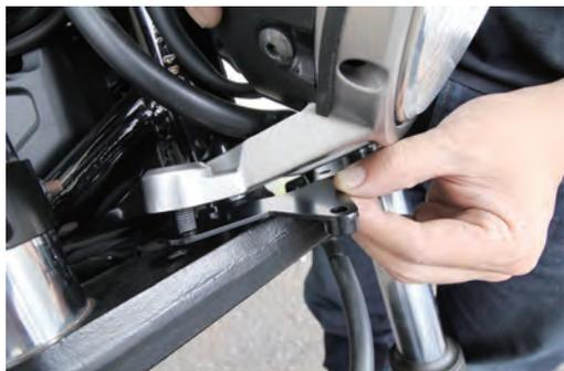
純正ヘッドライトステーを外し、付属のステーを上図のように挟み込み、ヘッドライトを固定する
