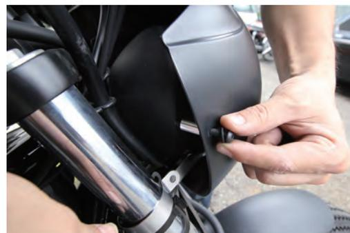
ビキニカウル横の穴にボルト、ワッシャー、カラーを使用し、クランプステーに固定する
