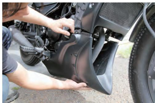
アンダーカウルの下側を装着する。 ※この時、ボルトは仮組みで全てのボルトを挿入後に本締めする事
