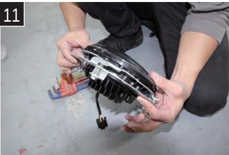
11 ライトユニットに固定用プレートを取り付ける。
