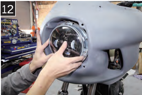
12 プレートを取り付けたライトユニットをカウルに固定する
