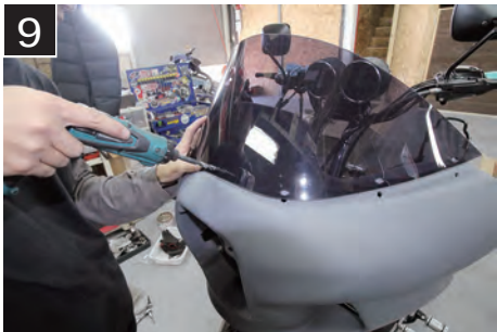
9 スクリーンをカウルに合わせ、ボルトの穴位置が合うように調整、穴あけ加工を行う
