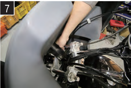
7 固定位置でハンドルを左右に切り、フォークとステーの干渉を確認する。
