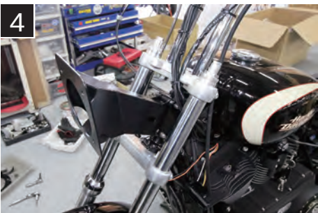
4 2で取り付けた台座ステーに ライト部固定ブラケット (画像参照) を連結し仮止めする
