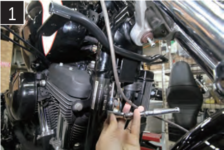
1 付属の カウル本体固定ステー を車体に仮止めする ※このステーはカウル本体、左右の固定に使用
