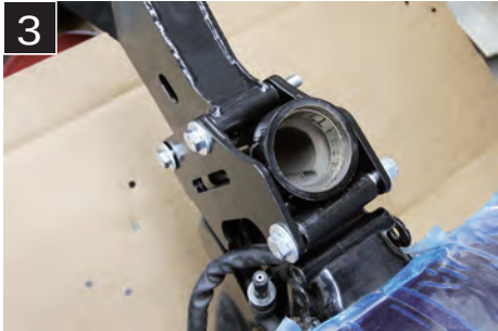
3 ダイナ用は上図のように、ネックに引っ掛けるかたちでステーを仮止めする
