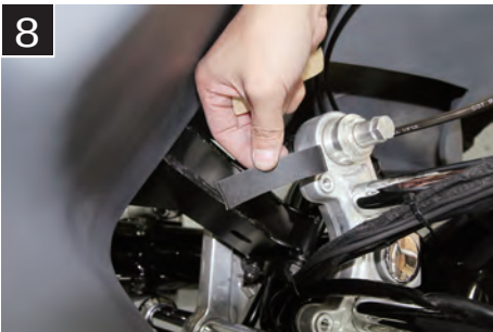
8 フォークとステーの干渉部分に付属の保護パットを貼り付ける
