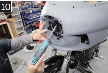
10 ライト部のスクリーンも同様にボルトの穴位置が合うように調整、穴あけ加工を行う
