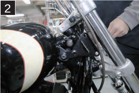
2 付属の 台座ステー をタンク固定ボルトに仮止めする ※穴付きプレートはフレーム番号の覗き穴となります ※このステーはライト部固定ブラケットの台座です
