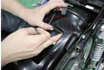
\* 付属のスポンジをバッテリー装着箇所の前後に貼り付けます。
