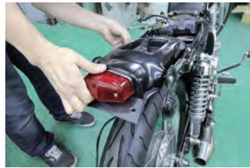
\* フェンダーを付属のボルト・ナットでフレームに装着します。
