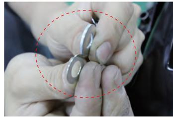
\* 厚みの異なるワッシャーが付属しております。このワッシャーでフェンダーとフレームの隙間を埋めて下さい（車体それぞれ、リアフレームの左右距離が僅かに異なるため）
