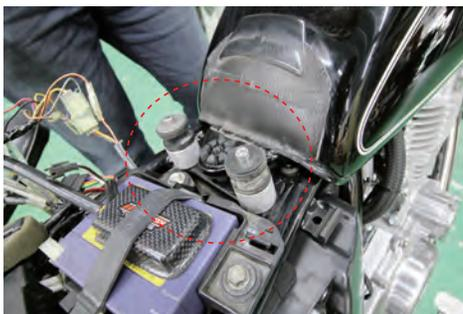
\* シートを取り外し、シート前側フレームに付いているシート固定部品を外す
