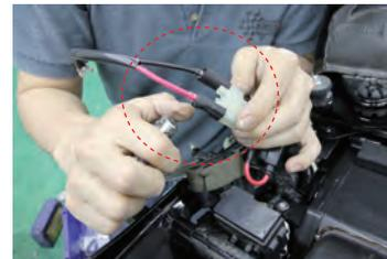
\* 付属の熱収縮チューブを差し込み端子に被せ、ヒートガンなどで収縮させ絶縁させます
