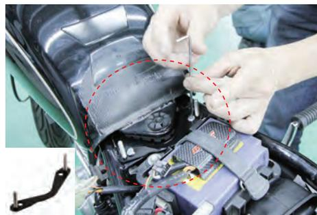
\* 付属のオフセットステーを付属のボルトでフレームに固定する
