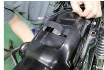
\* 付属のマジックテープをフェンダーのバッテリー収納箇所へ装着します
