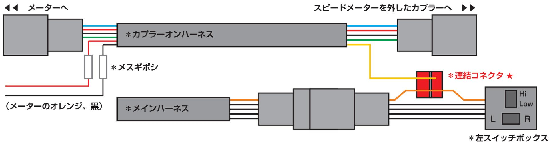
★ ハンドル左側スイッチボックスのハーネス、オレンジの線（ウインカー電源の配線）に連結コネクタを接続します
