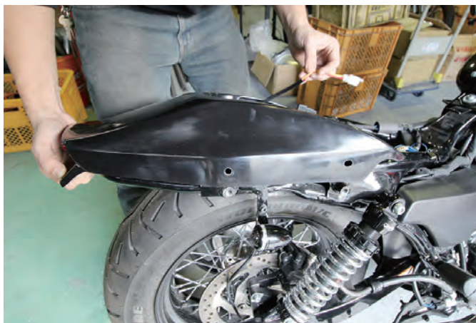
テールランプをセットした本製品をリアフレームに被せます。 ※配線の挟み込みにご注意ください
