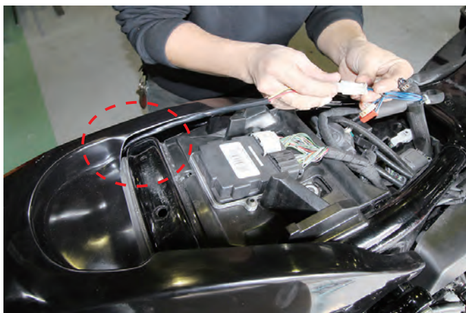
上図のように配線を逃がしている事を確認の上、テールの配線を接続します
